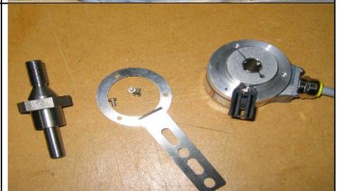
Schrauben Sie den Gewindedorn in die Bohrung der Antriebswelle ein. Alle Gewindedorne wurden auf Gleichlauf getestet.
