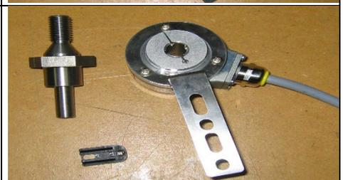
Schieben Sie vorsichtig mit der Hand, ohne Gebrauch von Werkzeug den Geber auf die Welle und fixieren Sie den Befestigungsring mit einem Inbusschlüssel.
