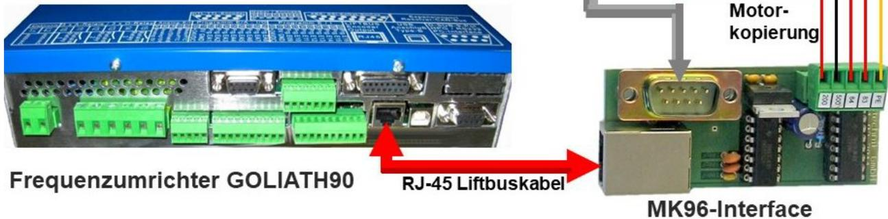
Der **MK96 Adapter** wird benötigt, wenn ein bewährter Goliath-60 Frequenzrichter gegen einen neuen Frequenzrichter der Baureihe GOLIATH-90 ersetzt wird, da der Frequenzrichter mit der Steuerung (DAVID-606, bzw. -2005) per **BUS** kommuniziert. Da der GOLIATH-60 eine 9 poligen D-Sub-Busleitung hatte, aber die GOLIATH-90 ein **RJ-45-Buskabelanschluß** hat, braucht man natürlich einen Adapter!
