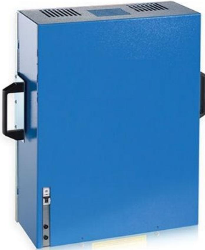
Kompakte Rückspeiseeinheit für frequenzgeregelter Seil- und Hydraulikaufzugsanlagen. Die Leistungsbandbreite erstreckt sich von **4 kW bis 40 kW**. Das Gehäuse besteht vollständig aus Metall. Der EMV-Grenzwert analog der EN12015 wird eingehalten. Der Standby-Energiebedarf beträgt 3W. Nach einer Minute nach dem Abschalten des Motors schaltet sich das System aus. Bei der nächsten Aktivierung eines neuen Befehls wird es wieder eingeschaltet und ist bereit, Energie zurückzugewinnen.
