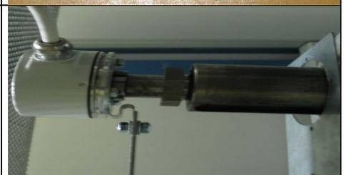
Bei **Synchronmaschinen / Gearless** ist der Absolutwertgeber an der Maschine montiert. Bei einer Gearless der Firma **Ziehl-Abegg** der Baureihen **SM 160 / 200 / 225 / 250 / 700 / 850 / 860** ..und der Firma **Alberto Sassi G100 / G200 / G300 / G400 / G500** ist ein EnDat-Geber mit einem 15-poligen Sub-D Stecker vorhanden, der direkt am Goliath-90-Absolutwertgebereingang angeschlossen werden kann.
