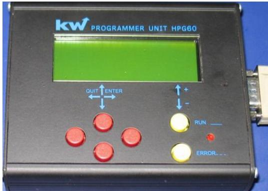
Das Handprogrammiergerät HPG60 ist das universelle Ein- und Ausgabegerät für das komplette Steuerungs- und Regelsystem. Es weist 6 Tasten, ein vierzeiliges LCD-Display, eine rote Leuchtdiode, sowie eine 9-polige RS232-Schnittstelle auf.
