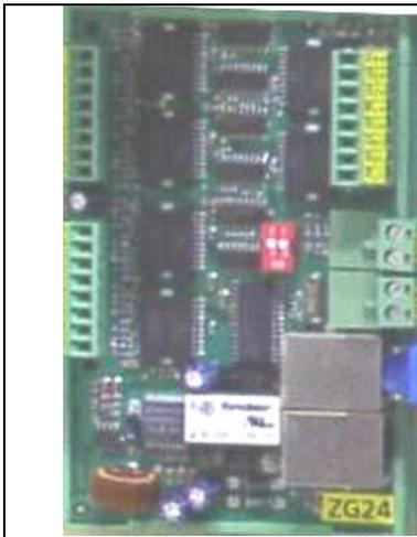
Die Zusatzgruppe ZG-24 bietet 24 zusätzliche Ein- und Ausgänge. Verbunden wird die ZG-24 mit einem Buskabel RJ45 und der Spannungsversorgung (200 und 500 ) mit der Zentraleinheit ZR oder dem Schachtbus. Die Ein- und Ausgangsbelegung ist frei wählbar. Es können bis zu 4 Zusatzgruppen in einem Steuerungssystem betrieben werden.
