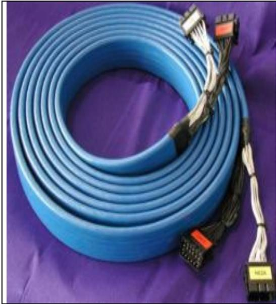
Das Hängekabel EHK40 stellt die Verbindung zwischen dem Zentralrechner und dem Fahrkorbrechner dar. Von der physikalischen Struktur des Hängekabels sind Aufzugsanlagen mit einer Haltestellenanzahl von bis zu 32 Haltestellen realisierbar. Das Hängekabel wird nach Kundenvorgabe konfektioniert und an den Enden mit unterschiedlichen, verpolungssicheren Steckverbindungen ausgestattet.
