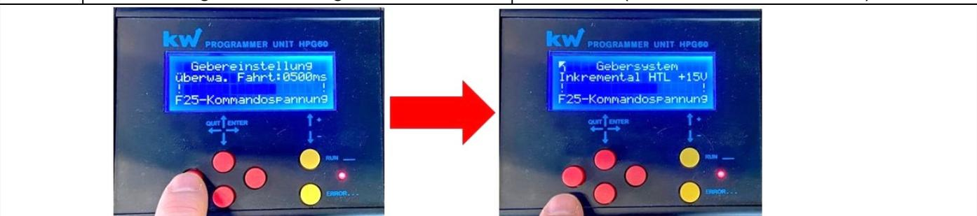
**Rückkehr ins Menü A4 Motor / Getriebe – Synchronmaschine: > Taster QUIT drücken!**
